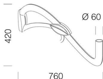
braccio in alluminio pressofuso completo di cavo di alimentazione con guaine esterna in PVC e conduttori in doppio isolamento sezione 2x1mmq. viteria in acciaio inox.
