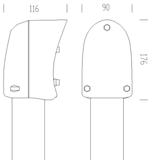
Corpo in nylon f.v. permette l'installazione su palo  $\varnothing$  60.
