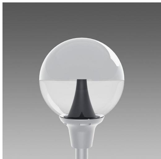
Globo: In policarbonato infrangibile ed autoestinguento V2, stabilizzato ai raggi UV, antingiallimento. Ottima trasparenza ideale per la trasmissione del flusso luminoso. Parte superiore verniciata per rientrare nelle limitazioni delle norme contro l'inquinamento luminoso.
