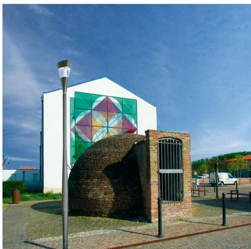
Pali realizzati in lega di alluminio spazzolato 6060 fluoformato. Con finestra d' ispezione, completa di 2 portafusibili di protezione, 2 fusibili da 10A, morsettiere asportabile. Grazie al loro profilo, risultano particolarmente adatti nelle città e nei comuni con una forte personalità. Sezione cilindroconica con diametro di 180 o 150 mm alla base, che consente di disporre di un ampio spazio in corrispondenza del piede della piantana per l'alloggiamento dei dispositivi elettrici.
