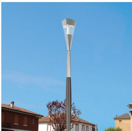
Pali realizzati in lega di alluminio spazzolato 6060 fluoformato. Con finestra d' ispezione, completa di 2 portafusibili di protezione, 2 fusibili da 10A, morsetti asportabile. Grazie al loro profilo, risultano particolarmente adatti nelle città e nei comuni con una forte personalità. Sezione cilindroconica con diametro di 180 o 150 mm alla base, che consente di disporre di un ampio spazio in corrispondenza del piede della piantana per l'alloggiamento dei dispositivi elettrici.
