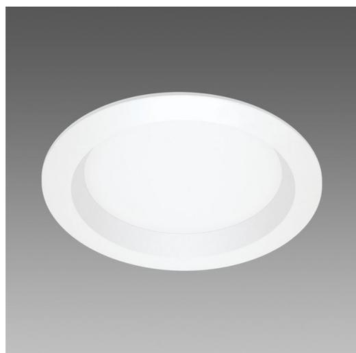
La caratteristica principale di questo apparecchio è la tecnologia di "cambio tonalità": mediante il selettore integrato di serie posizionato sul corpo è possibile scegliere la temperatura di colore preferita (3000K/3137lm - 3500K/3233lm - 4000K/3235lm), adattandosi così alla maggior parte delle installazioni.
