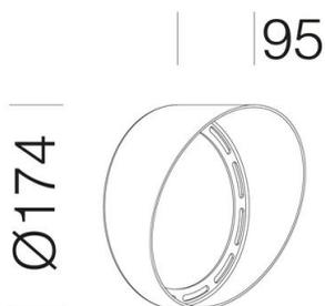
In alluminio verniciato. Permette di convogliare il fascio luminoso in un'unica direzione. Per Cripto small.
