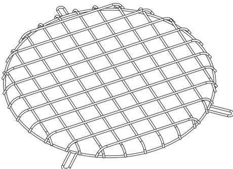
Corpo in tondino di acciaio plastificato. Per la protezione antiurto (esclusa versione COB).
