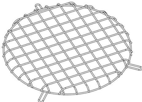
in tondino di acciaio plastificato. Per la protezione antiurto (esclusa versione COB).
