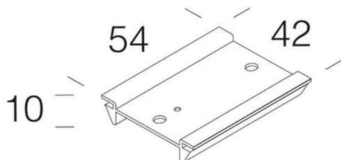
supporto per base sezionatore, da fissare a scatto sul canale art. 6000. Da usare anche come fermafilo.
