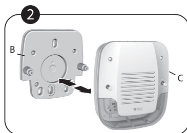
2 Separare il supporto a muro (B) della sirena (C).
