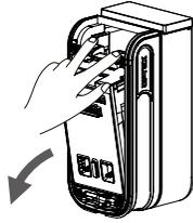
2 Premere sulle linguette blu per separare la parte del rilevatore dalla base.
