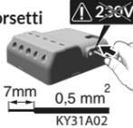
**Non spelare i fili quando sono collegati al prodotto, per evitare il rischio di danneggiare il connettore interno.**
