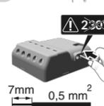
**Strip de kabels niet wanneer deze zijn aangesloten op het product om de interne connector niet te beschadigen.**
