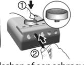
Gebruik het meegeleverde gereedschap of een schroevendraaier van 2,5 mm om op de knop van de klem te drukken om de kabel in te brengen.
