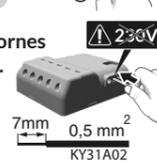
**Ne pas dénuder les fils lorsqu'ils sont connectés sur le produit au risque d'endommager le connecteur interne.**
