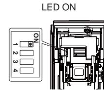
Positionnez le switch 1 en mode **TEST (ON)**.
