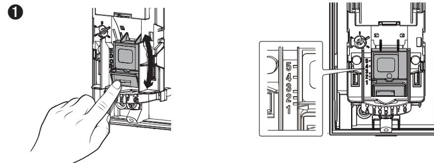
Réglez la longueur de détection en faisant glisser la cellule infrarouge basse sur la position souhaitée.
