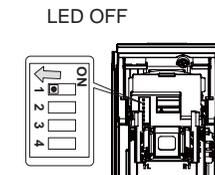
Une fois le test terminé, positionnez le switch 1 en mode **NORM (OFF)**, puis refermez le boîtier.
