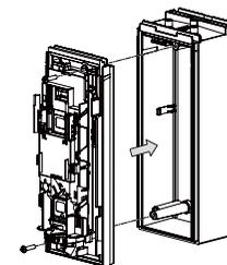
Repositionner l'ensemble capteur /carte électronique dans le support arrière et fixez le.
