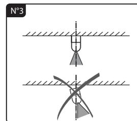
Installez le détecteur à la verticale, avec les zones de détections hautes et basses parallèles au mur.
