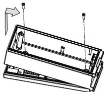
Otez les vis de fixation et retirez
