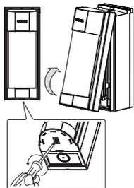
Otez la vis de fixation du capot et retirez le capot.
