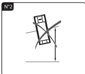
Installez le détecteur à la verticale, avec les zones de détections hautes parallèles au sol.
