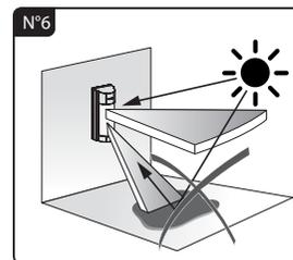
Ne pas diriger la zone de détection basse vers des surfaces réfléchissantes (flaque, fenêtre, etc.).
