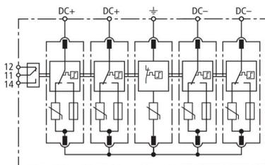
Schema di principio DG M PV2 SCI 1000 FM
