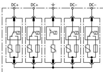
Schema di principio DG M PV2 SCI 1000
