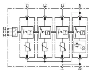
Schema di principio DG M H TT 275 FM
