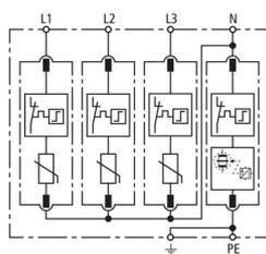
Schema di principio DG M H TT 275
