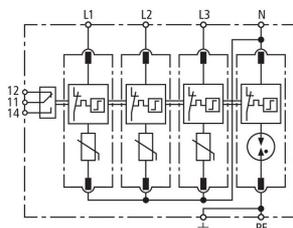
Schema di principio DG M TT 385/305 FM
