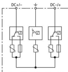
Schema di principio DG YPV SCI 1000
