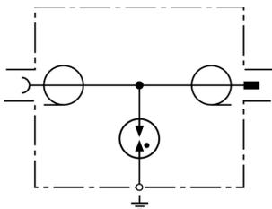
Schema di principio DGA G SMA
