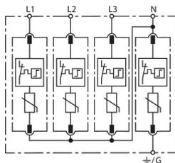
Schema di principio DG MU 3PY 480 4W+G
