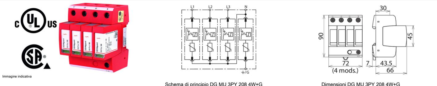
Schema di principio DG MU 3PY 208 4W+G
