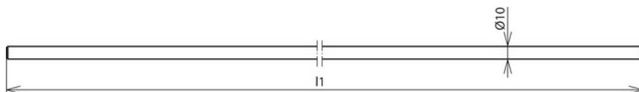
Per il collegamento delle calate all'impianto di terra, in acciaio inossidabile INOX (AISI 316).
