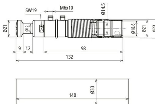
Un elemento di connessione isolante per la terminazione della condotta HVI light plus in caso di posa all'interno del tubo. Grazie all'utilizzo di elementi di connessione isolanti, è possibile eseguire una verifica di isolamento sulla condotta HVI light plus. Questo elemento di connessione isolante può essere utilizzato per la posa all'interno del tubo in tubi portanti Ø 40 mm e Ø 50 mm.
