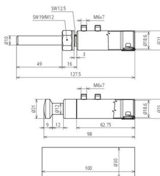
Due elementi di connessione per collegare la condotta HVI light plus su entrambe le estremità. Un elemento di connessione per la realizzazione della connessione terminale della condotta nel tubo portante (elemento terminale) e un elemento di connessione per il collegamento ad altri parti della protezione dai fulmini esterna o dell'impianto di messa a terra (incl. due tubi termorestringenti). Questi elementi di connessione possono essere utilizzati con i tubi portanti per HVI light plus.
