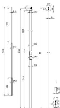
Tubo portante con terminale interno ed elemento a molla per l'equipotenzialità. Asta di captazione Ø22 / 16 / 10 mm.
