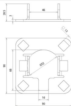
Piastra di connessione (quadrupla) per il montaggio della condotta HVI light plus sul tubo portante Ø 40 mm (ad es. art. n. 105 672, 105 673, 105 677, 105 678).
