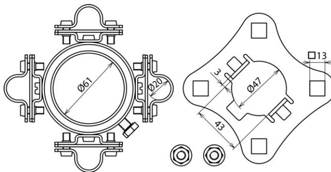
Set di fissaggio per il montaggio della condotta HVI long sui tubi portanti HVI long, composto da piastra di connessione (quadrupla, compresi due dadi zigrinati) e anello di fissaggio con quattro staffe portafilo fessurate (Ø 20 mm) per la connessione terminale (comprese due fascette con semigusci di supporto in materiale plastico).
