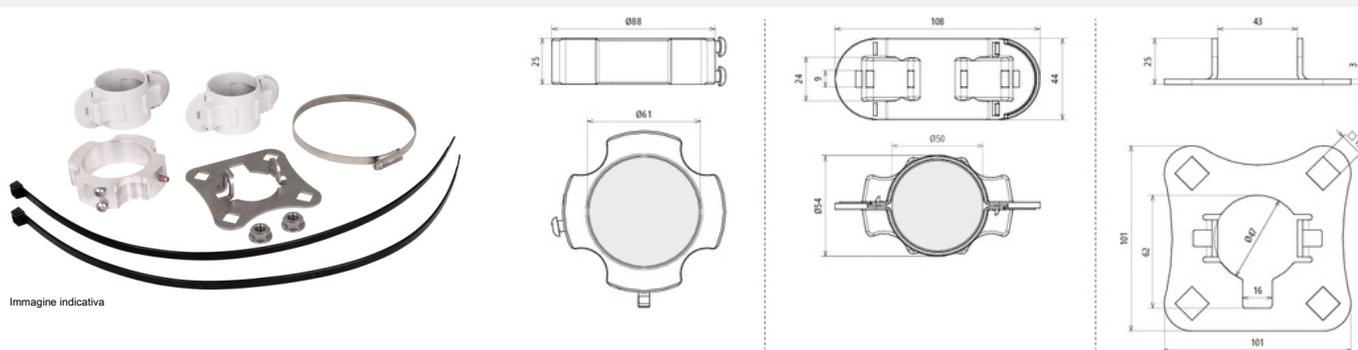
Set di fissaggio per il montaggio della condotta HVI light plus sui tubi portanti HVI Ø 50 mm, composto da piastra di connessione e anello di fissaggio con fascetta serracavo in acciaio inox per la connessione terminale (incl. quattro semisupporti in plastica e due fermacavo).
