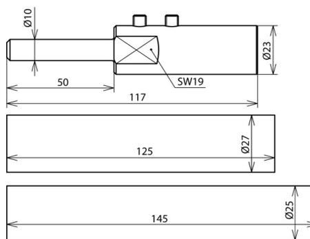
Elemento di connessione per la terminazione della condotta HVI long, per la realizzazione della connessione terminale della condotta per altre parti della protezione dai fulmini esterna o dell'impianto di messa a terra (incl. due tubi termorestringenti, 1 nero, 1 grigio).
