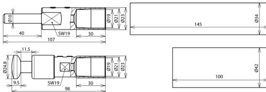
Elementi di connessione per la terminazione della condotta HVI long su entrambe le estremità; per la realizzazione della connessione terminale della condotta nel tubo portante (elemento terminale) ed elemento di connessione per il collegamento ad altri componenti della protezione dai fulmini esterna o dell'impianto di messa a terra (compresi quattro tubi termorestringenti, 2 neri, 2 grigi).
