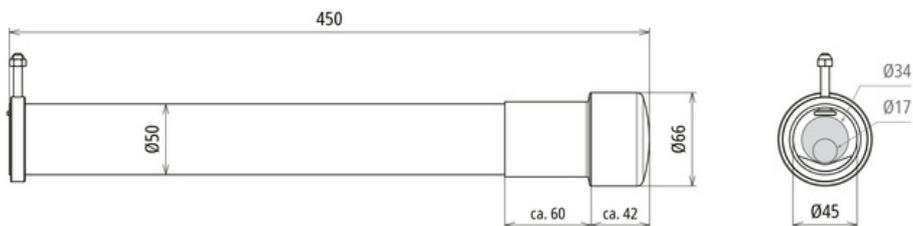
Cappucci isolanti per la verifica dell'isolamento sulle calate isolate resistenti alle alte tensioni
