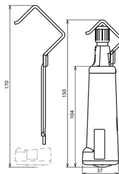
L'attrezzo può essere usato per la rimozione del rivestimento grigio supplementare della conduttura HVI Light e HVI. DEHNhelix è costituito da una manopola e inoltre una presa ad archetto sostituibile (in base al diametro del conduttore).
