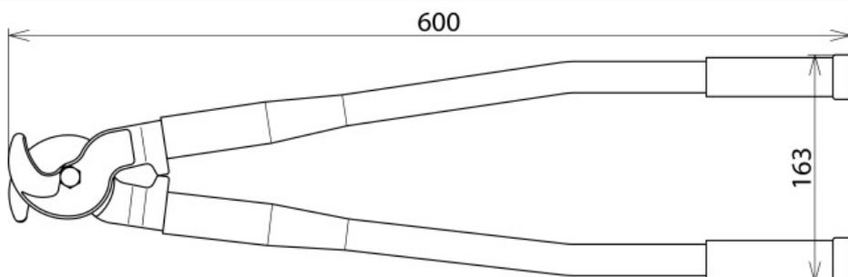
Cesioie per cavo per poter accorciare semplicemente la condotta HVI light, HVI (diametro esterno 20 / 23 mm) e HVI power (diametro esterno 27 mm) e per la condotta CUI.
