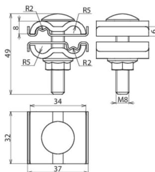
Morsetto di collegamento per collegare reti magliate con impianti di terra.
