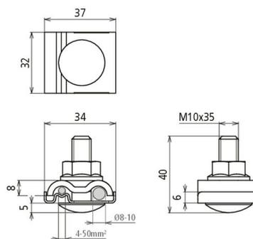
Morsetto di messa a terra per integrazione di parti dell'impianto nel collegamento equipotenziale funzionale, nel collegamento equipotenziale antifulmine o nella messa a terra funzionale. Piastra di contatto con cavalletto doppio di fissaggio. Versione in acciaio inox con vite M10 e dado zigrinato.
