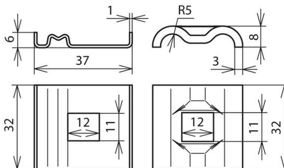
Morsetto di messa a terra per integrazione dei sistemi di montaggio p.es. di impianti FV, nell'equipotenzialità funzionale/messa a terra funzionale (colore del conduttore nero) ed equipotenzialità antifulmine secondo CEI EN 62305-3 (classificazione CEI 81-10/3)
