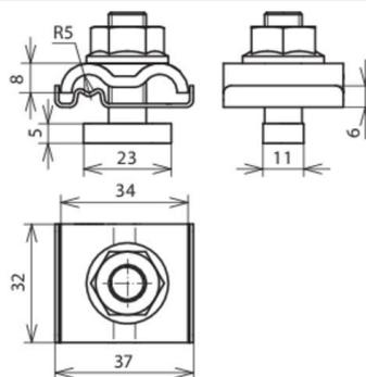
Morsetto di messa a terra per integrazione dei sistemi di montaggio p.es. di impianti FV, nell'equipotenzialità funzionale/messa a terra funzionale (colore del conduttore nero) ed equipotenzialità antifulmine secondo CEI EN 62305-3 (classificazione CEI 81-10/3)
