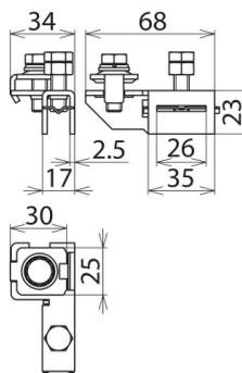
Da combinare con nastro per fascette (art. n. 540 901), sezione di collegamento 4-50 mm<sup>2</sup> (rigido / semirigido).
