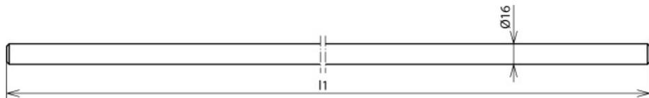
Asta di captazione bombata su entrambi i lati, per la protezione di costruzioni su tetto, camini ecc., specialmente per zoccolo in cemento (17 Kg) con cuneo o per il fissaggio con cavallotti / distanziatori.
