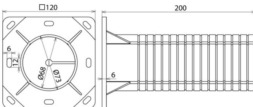
Esecuzione con anima in polistirolo (nessun ponte termico) da combinare con la cassetta di sezionamento. Si può accorciare il distanziatore in gradini di 10 mm da 200 a 50 mm.
