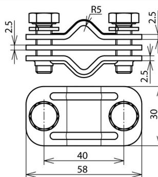
Morsetto di sezionamento con grova per collegare un'asta di captazione con un conduttore ovvero una calata con l'adduzione a terra. Portata di corrente di fulmine provata fino a 200 kA (10/350  $\mu$ s).
