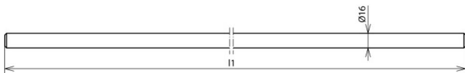
Conduttore di cortocircuito con  $\varnothing$  16 mm e bombatura su entrambe le estremità.
