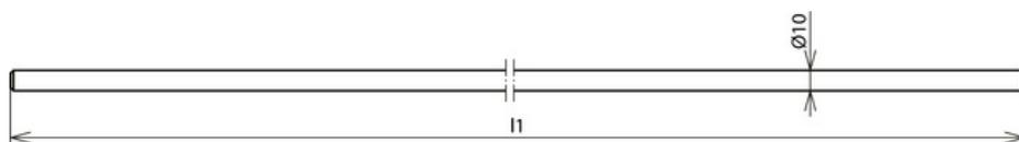
Conduttore di cortocircuito con Ø 10 mm e bombatura su entrambe le estremità.
