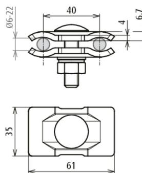
Supporto parallelo per conduttore di cortocircuito su gabbioni per pietre e staccionate in griglia metallica.
