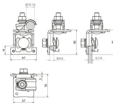
Supporto angolato per conduttore di cortocircuito su gabbioni per pietre e staccionate in griglia metallica.
