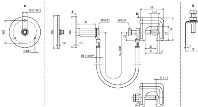
Set di collegamento costituito da conduttore di collegamento con morsetto di collegamento connesso e punto fisso di messa a terra.
