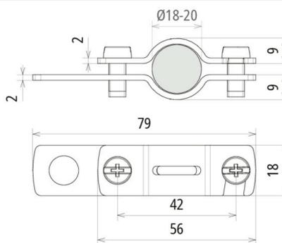
Per il processo di scarica del campo elettrico della condotta HVI light plus nella zona del terminale o in altri casi.
