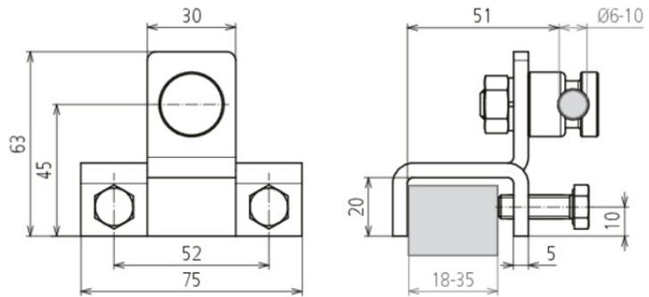
Versione pesante; per il collegamento a strutture in acciaio.
