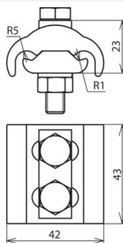
Morsetti con grova per collegare/connettere conduttori tondi/corde in zone con pericolo di esplosione Zona 1/21, 2/22. I morsetti sono autobloccanti secondo CEI EN 62305-3 allegato 2 (CEI 81-10/3 allegato 2).
